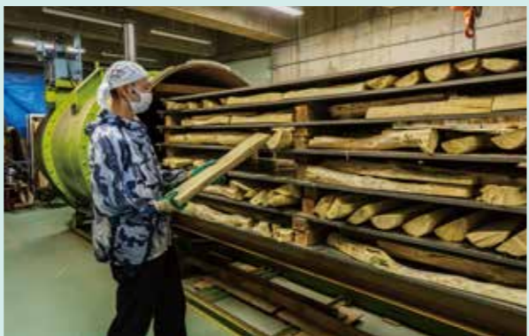
約800kgの原木を入れることができる乾燥機。時間と温度、真空度のバランスを調整しながら効率的に水分を取り除く。
